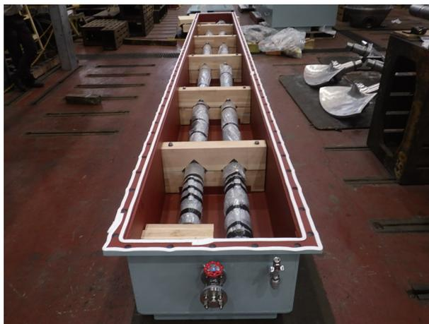
図7 可動翼ポンプ操作ロッド保管箱格納状況
