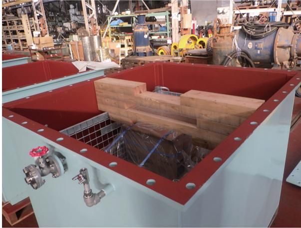
図8 可動翼ポンプ炭素鋼部品保管箱格納状況
