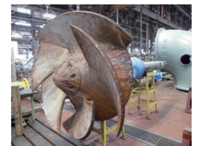
使用後約20年が経過したポンプ羽根車
