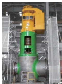
地熱発電用温水ポンプ
