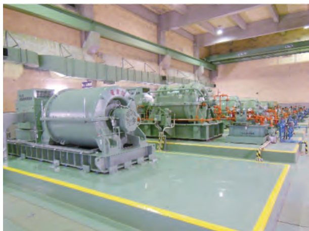
図6 アルミ合金インペラ採用多段ターボブロウ (AM-Turbo®)
