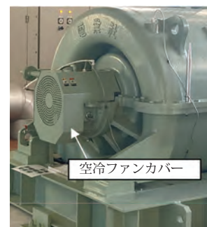
図5 空冷式ころがり軸受ユニット Fig.5 Air-cooled ball bearing unit
