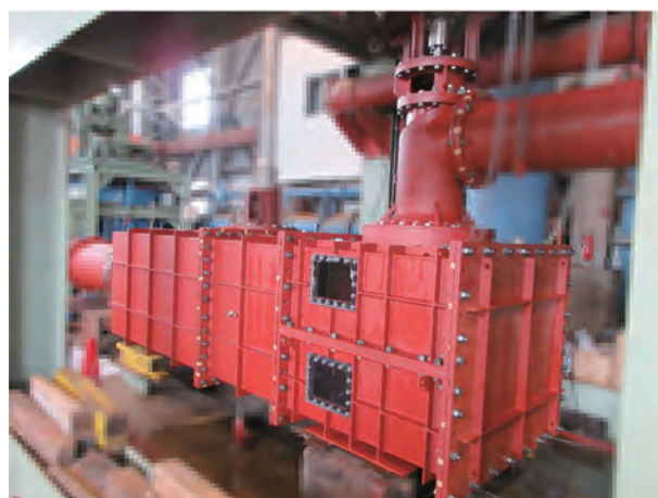
図8 模型ポンプ試験装置外観 Fig. 8 Model pump test equipment
