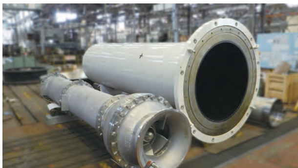
図5 温水ポンプ 床下組立品 バレルケース Fig. 5 View of the Hotwell pump assembly and barrel case
