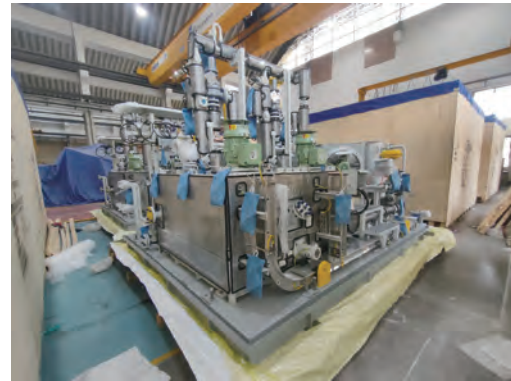
図6 強制給油装置外観 Fig.6 View of LO unit
