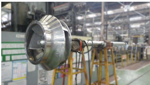
図4 温水ポンプ インペラ Fig. 4 View of the hotwell pump impellers
