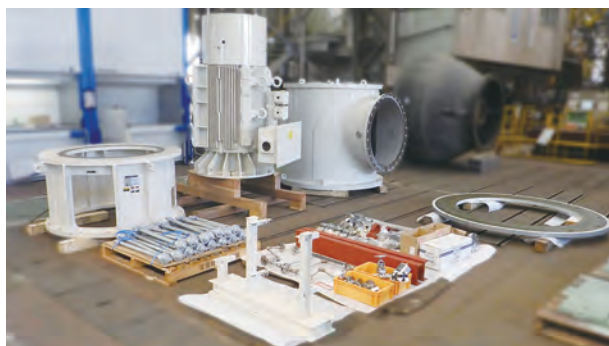
図6 温水ポンプ 床上部品 Fig. 6 View of the Hotwell pump parts
