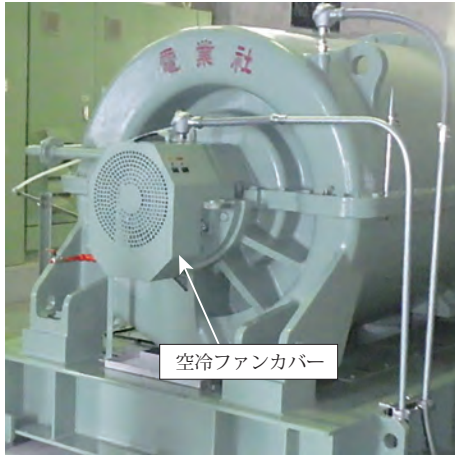
図5 空冷式ころがり軸受ユニット Fig.5 Air-cooled ball bearing unit
