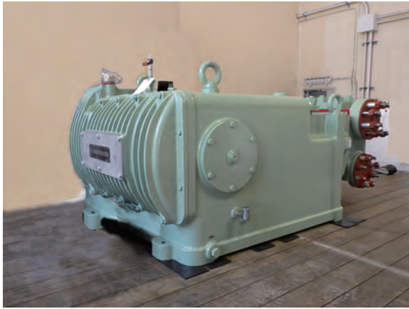
図5-1 熱延仕上圧延WRシフト油圧ポンプ
