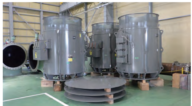
図8 海水取水ポンプ駆動用電動機
