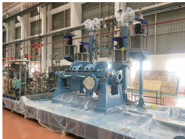
図7 DCIPL社でのポンプ組立状況 Fig. 7 Pump Assembly Status at DCIPL
