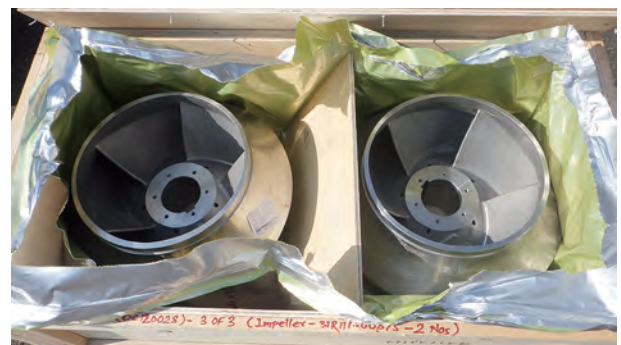
図2 海水取水ポンプ インペラ Fig.2 View of the seawater lift pump impellers
