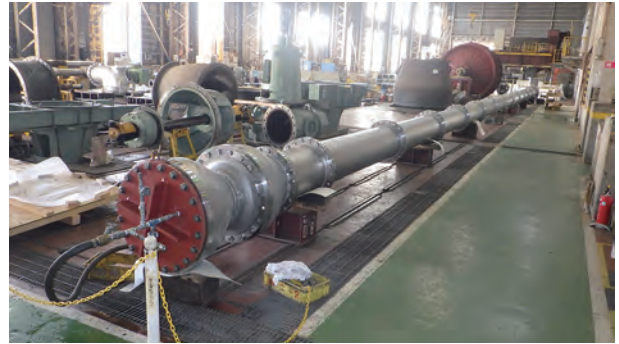
図6 耐圧試験の様子
