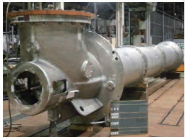
図2 気化器海水ポンプ外観
