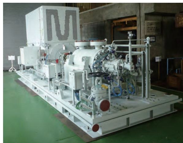
図5 完成ポンプ全体写真 Fig.5 Photograph of complete pump
