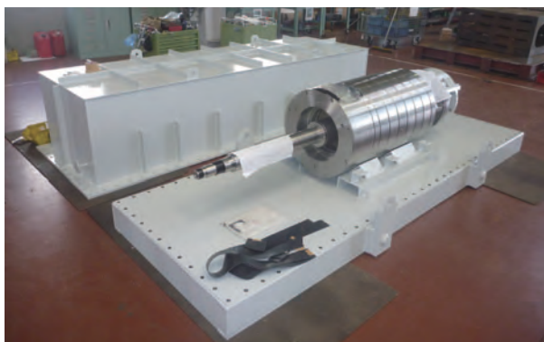
図6 予備エレメント用保管箱 Fig. 6 Storage box for spare element
