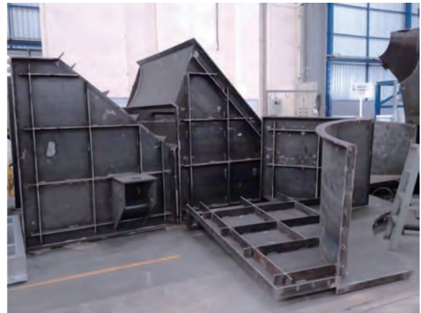
図3 ケーシングの製作状況 Fig.3 Manufacturing for casing
