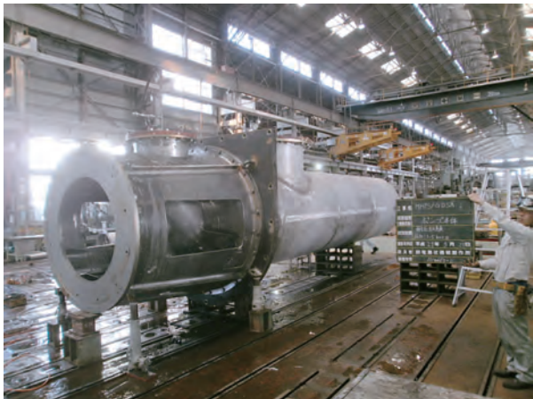
図7 ポンプ製作中
