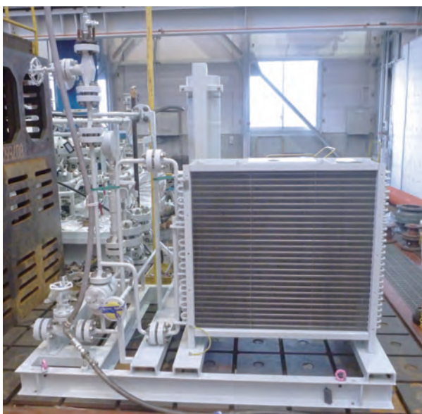
図5 Plan53Bシールシステム
