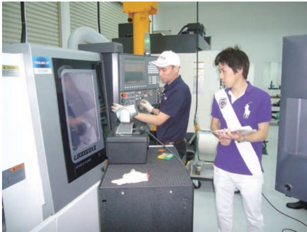
(a) CNC旋盤にてテスト加工の様子
