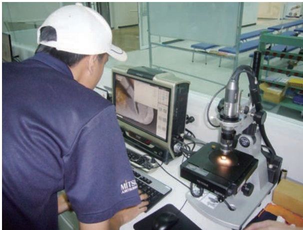
(b) Digital Micro Scopeによる刃先の検証
