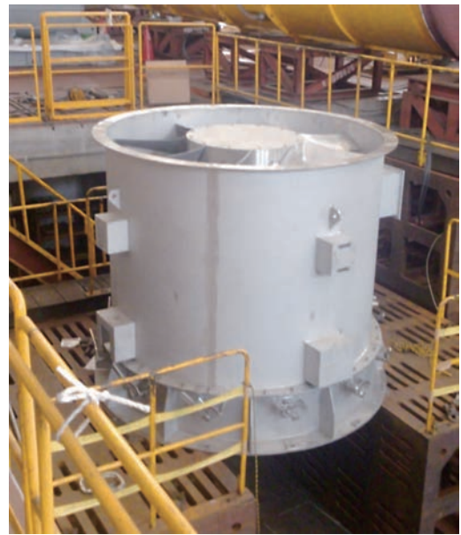
図17 口径2 000 mm立型軸流ファン
