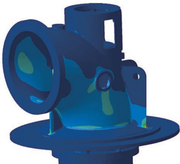
図5 FEM解析図（ノズルロード）
