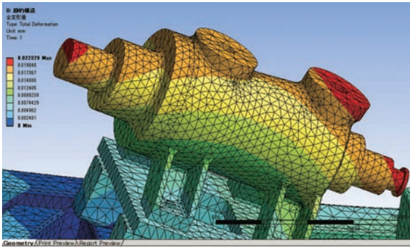
図8 軸変位 Fig.8 Shaft displacement
