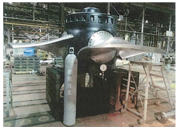
図4 主ポンプ漏洩試験状況 Fig.4 Leakage test situation of main pump
