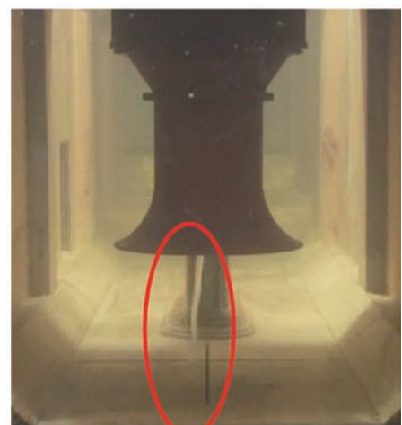
図8 模型試験結果 (左: 空気吸込渦、右: 水中渦) Fig. 8 Result of model test (left: Air-intake vortex, right: submerged vortex)
