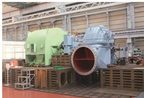
図15 口径1 200×1 000 mm両吸込ターボブロワ外観
