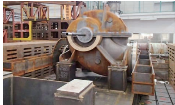
図2 実機を用いたノズルロード試験 Fig.2 Nozzle Load Test
