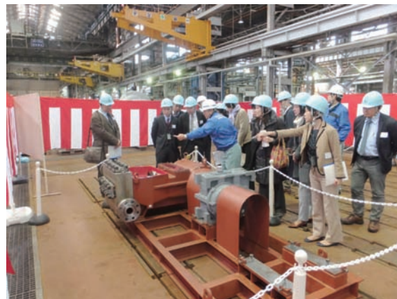
図5 往復プランジャポンプの説明状況
