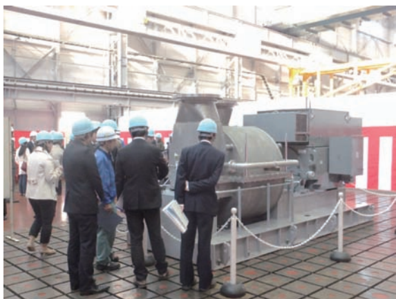
図7 鋼板製多段ブロウの説明状況
