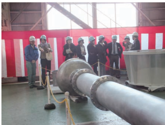
図3 立軸斜流ポンプの説明状況
