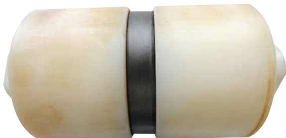
図3 ピストン（1500時間運転後） Fig.3 Piston (after 1500 hours operation)
