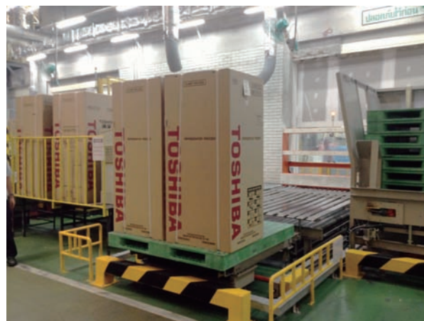
図4 梱包された冷蔵庫をパレットへ乗せる機械 Fig.4 Machine to put refrigerator on a pallet
