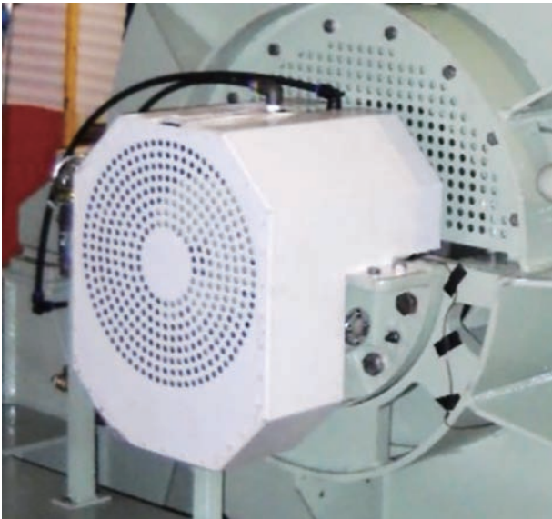
図5 空冷式ころがり軸受ユニット外観 Fig.5 Outline of anti friction bearing unit
