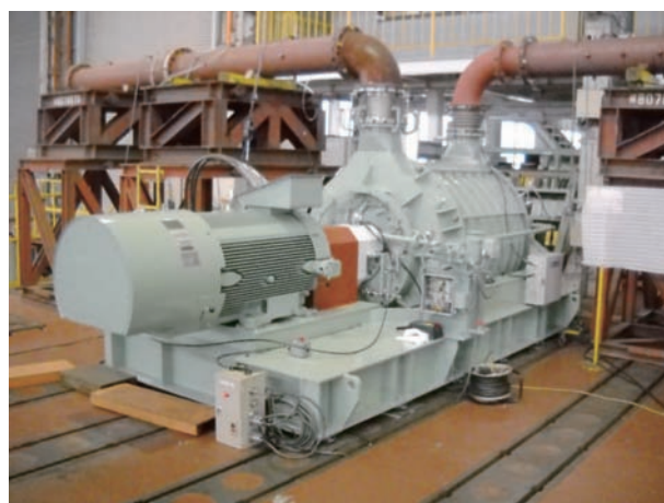
図4 社内試運転 Fig.4 Shop test
