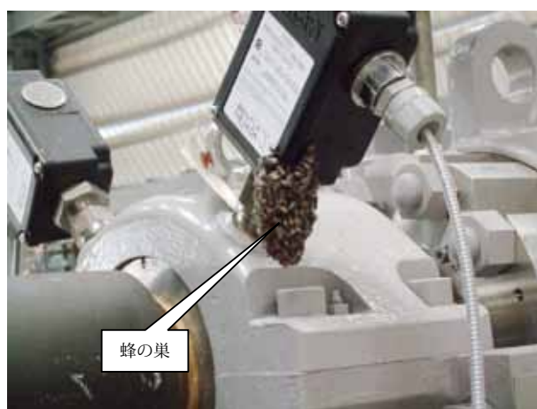
図6 軸振動センサー部に形成された蜂の巣 Fig.6 The hive formed in the vibration sensor part
