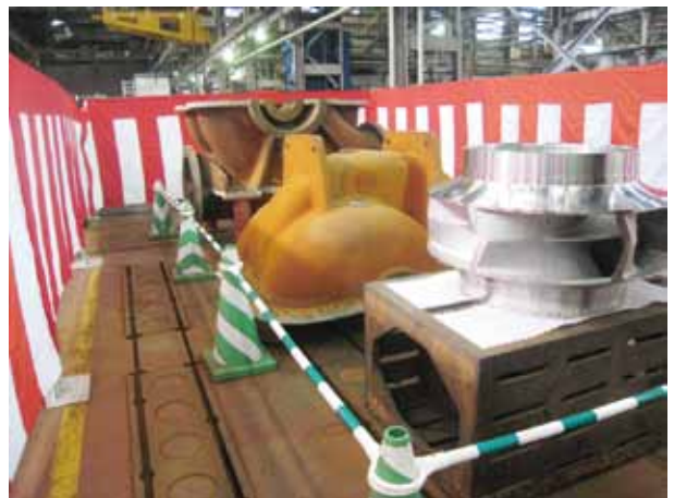
図2 両吸込渦巻ポンプの展示状況
