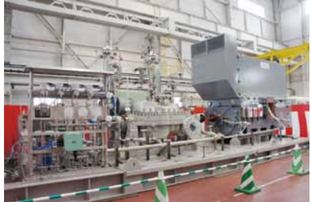
図1 水平二ツ割横軸高圧多段ポンプの展示状況
