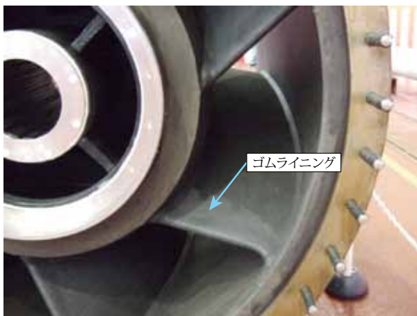
図3 ゴムライニング施工写真(吐出しボウル内面) Fig.3 Picture of rubber lining
