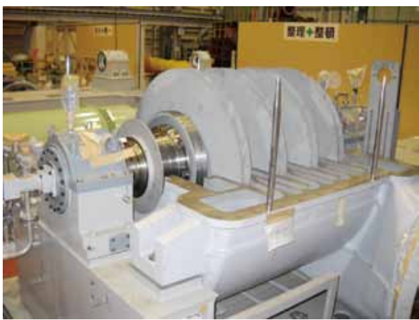
図3 上ケーシング取り外した状態 Fig.3 View of situation that removed an upper casing
