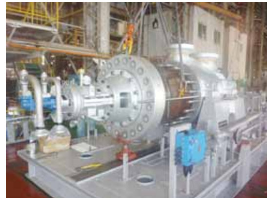
図3 カートリッジ構造 Fig.3 Cartridge configuration
