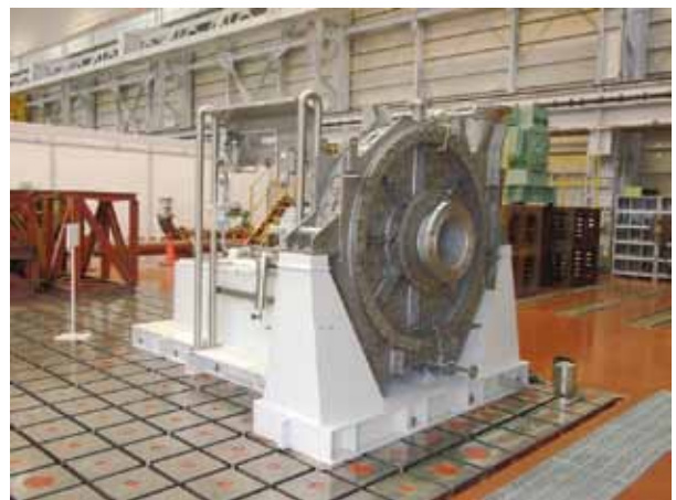
図17 ブロワ組立状況
