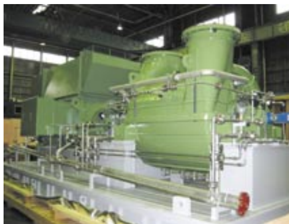
図4 プロウ外観(鋳鉄製ケーシング) Fig. 4 General view of blower (Casting casing)
