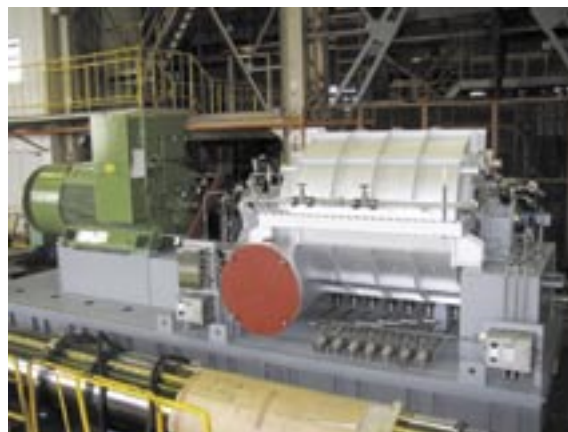
図3 プロウ外観(鋼板製ケーシング) Fig. 3 General view of blower (Steel casing)
