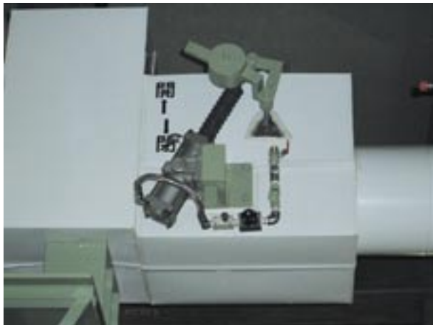
図15 エア・アシスト型省エネ逆止弁 (AA チェッキ)
