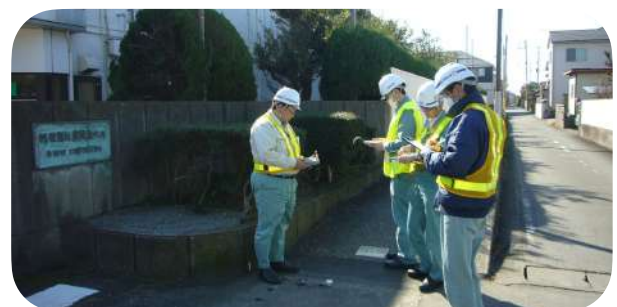
敷地境界の騒音・振動測定
