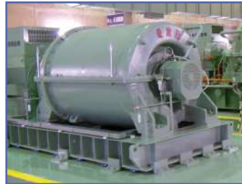
アルミ合金インペラ採用多段ターボブロウ (AM-Turbo)
