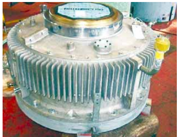
図7 2号機スラスト軸受ユニット Fig. 7 Thrust bearing unit of No.2
