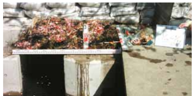
図12 取り出された浮遊ゴミ Fig.12 Raked drift-rubbish
