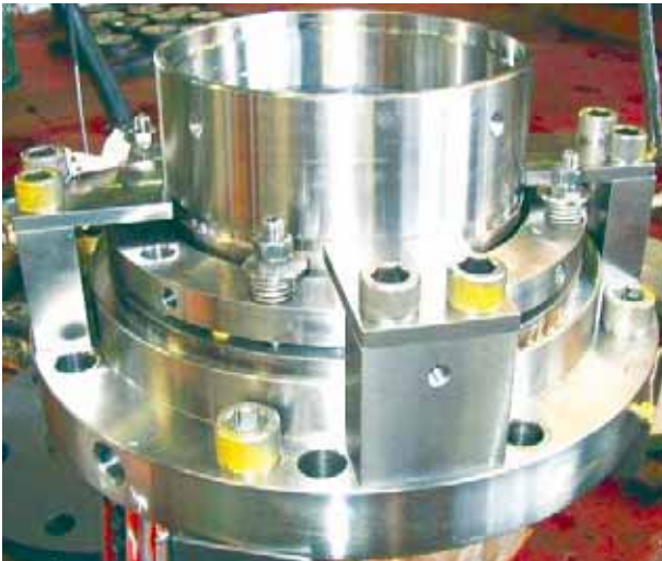
図8 メカニカルシール Fig. 8 Mechanical seal
