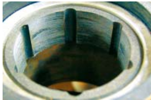
図3 水中負荷試験後の軸受摺動面 Fig. 3 Bearing after load test in water
