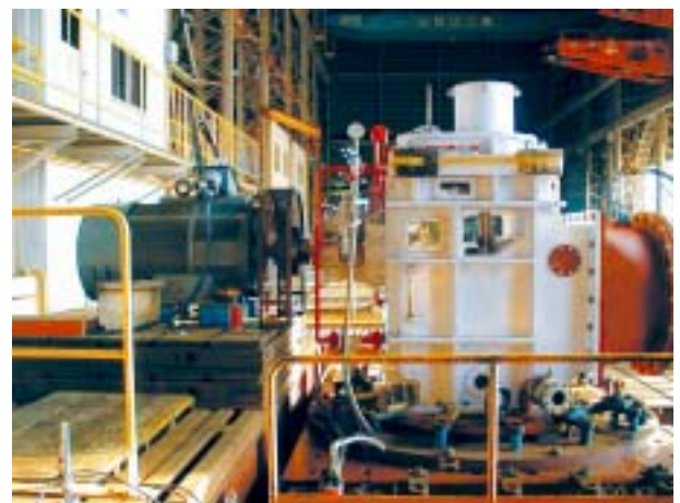
図6 実証試験ポンプ外観 (床上部) Fig. 6 Running test pump (part above ground)
