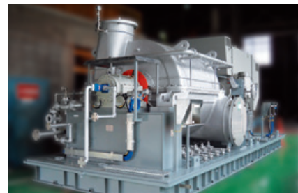
● 石油化学プラント向け送風機
