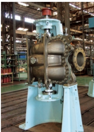
●浮体式海洋石油・ガス生産貯蔵積出設備用海水取水ポンプ
