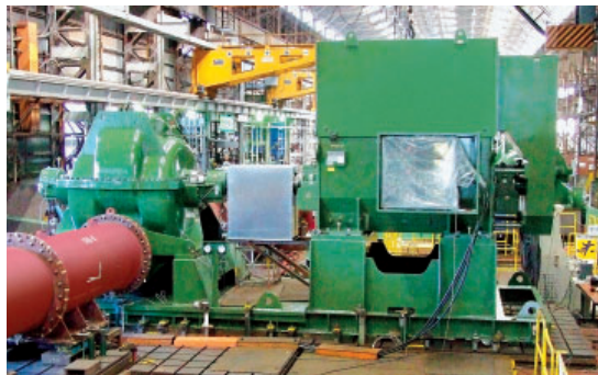
●肥料プラント向け（冷却水循環用）両吸込渦巻ポンプ
