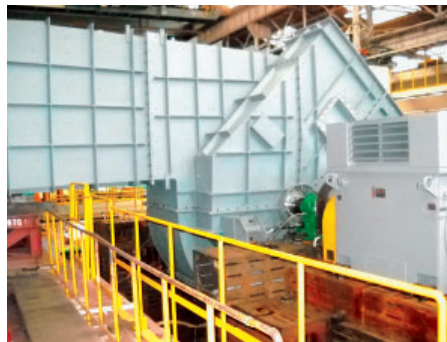
●肥料プラント向け（尿素製造設備用）両吸込ターボ送風機
