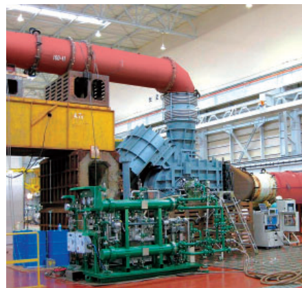
●海外肥料プラント用 2段ブロウ工場試運転状況
